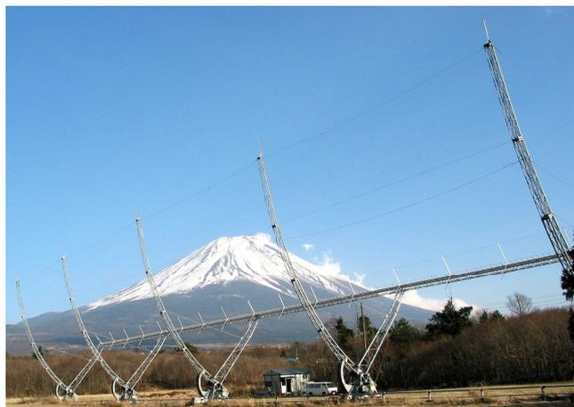
名古屋大学太陽地球環境研究所富士観測所に設置された太陽風観測専用の大型アンテナ。このアンテナを含め4台の大型アンテナで同時に惑星間空間シンチレーションを観測することで地上から太陽風の測定を行っている。本研究では、本装置によって取得された太陽風データが用いられた。
