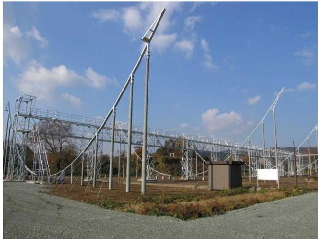
名古屋大学太陽地球環境研究所豊川観測所に設置された惑星間空間シンチレーション（IPS）観測専用の大型アンテナ（太陽圏イメージング装置、SWIFT）。本装置は、一日に数多くの電波天体のIPS現象を観測することができる。また本装置による観測は毎日連続して実施されている。これらにより時々刻々と移動する彗星のプラズマ尾を効率よく捉えることが可能となる。
