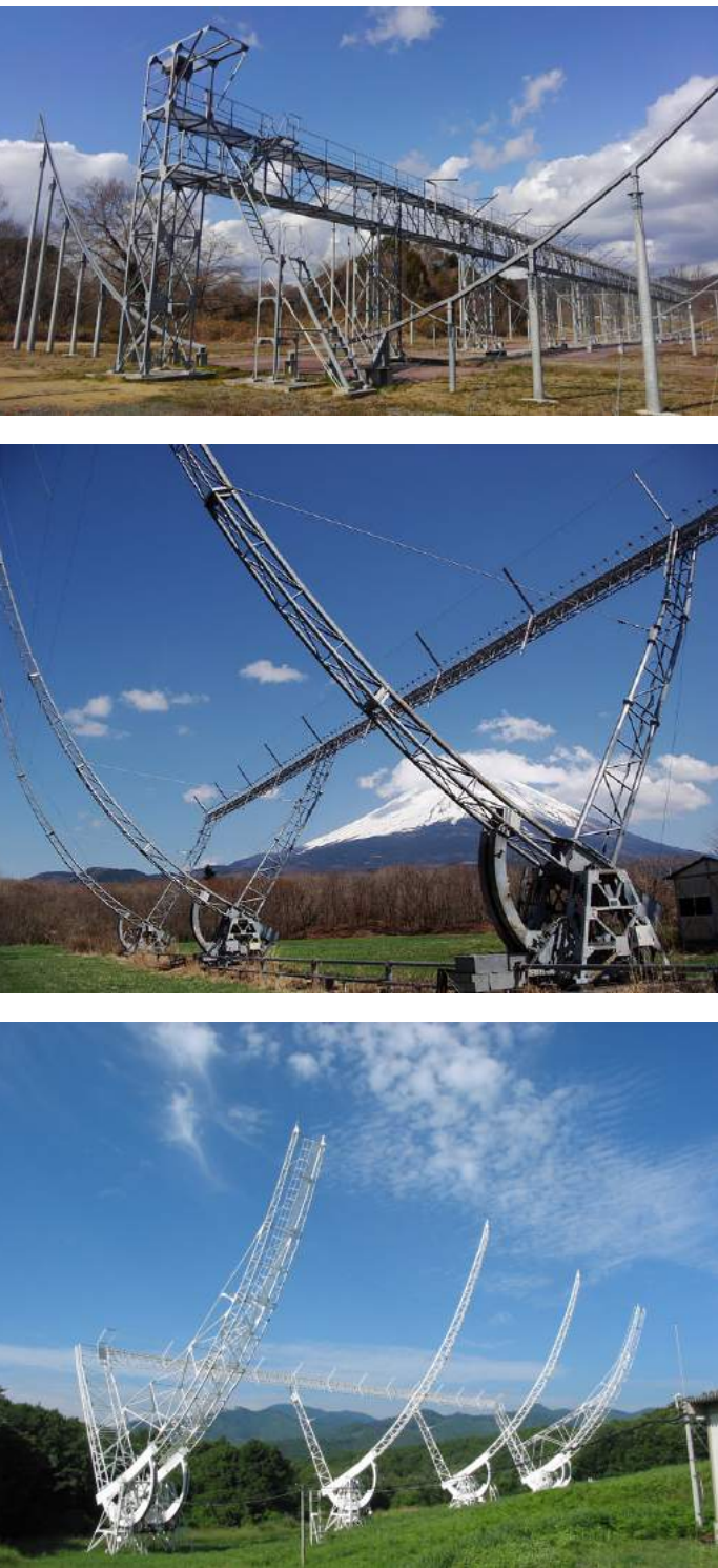
図2. (上から)豊川分室、富士観測所、木曾観測施設に設置されたIPS観測専用の大型アンテナ
