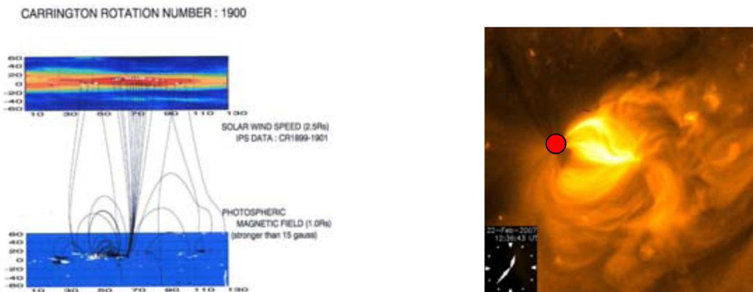
図6. 左図: IPS トモグラフィーで得られた低速太陽風(赤色領域)の源をコロナ磁場に沿い太陽光球面までたどると, 流源が閉磁場の端の小さなコロナホールであることがわかる. 右図: 太陽観測衛星「ひので」のX線望遠鏡の観測. 活動領域の左端にある赤丸印の領域からプラズマが絶えず噴出ししており, その様子は左の低速風流源の様子とよく似ている.
