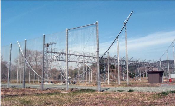
図2：太陽圏イメージング装置のUHF シンドリカルパラボラアンテナ。
