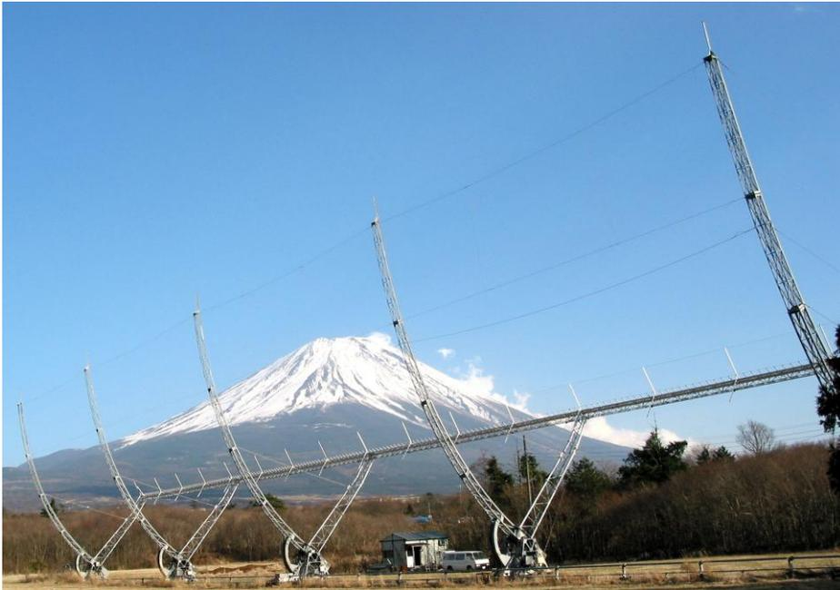
富士観測所に設置されているシリンダー型パラボラアンテナ。アンテナは、東西に配置された5基のパラボラ枠からなり、枠間に直径0.3mmのステンレス線を3cm間隔で張り、2000m<sup>2</sup>のパラボラ反射面が作られています。観測は全て自動化されており、データは名古屋の研究所に準実時間で送られています。同型のアンテナが他の観測点にも設置されています。
